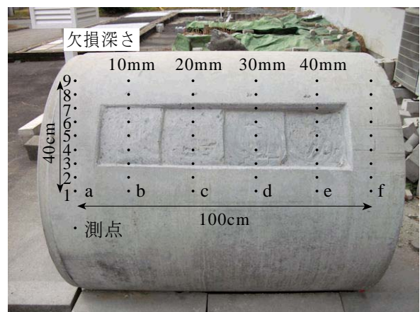
図-12 RC管の模擬欠陥の状況
