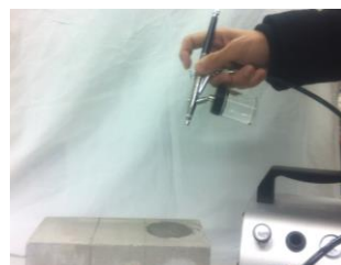
写真-1 表面吸水試験における散水噴霧状況
