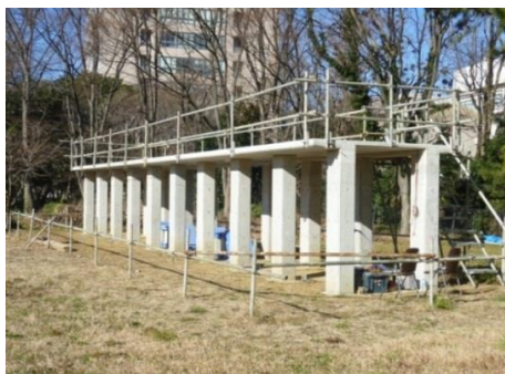
写真-1 検討に使用した中規模柱試験体
