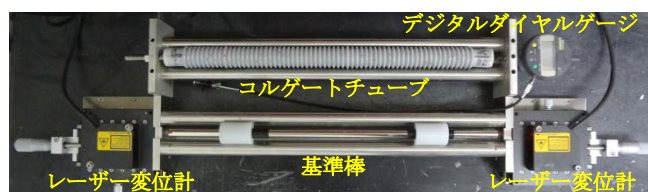
図-2 長さ変化測定装置
