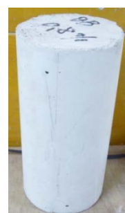
図-4 環境配慮型コンクリートの表面状況
