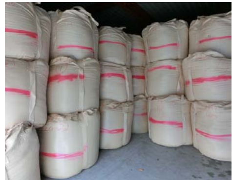
写真-1 焼却灰の保管例
