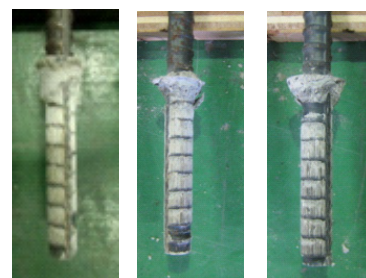
写真－2 引き抜き試験後のアンカー筋状況
