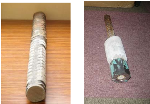
(a)鉄筋引抜け (b)グラウト引抜け
