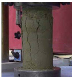
(a) 一軸圧縮試験状況 (粘性土)
