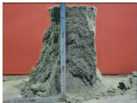
写真-2 ソイルセメント内のせん断コーン ( V=3.0 m/s)
