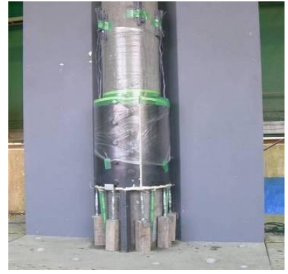
写真-8 モルタル充填後
