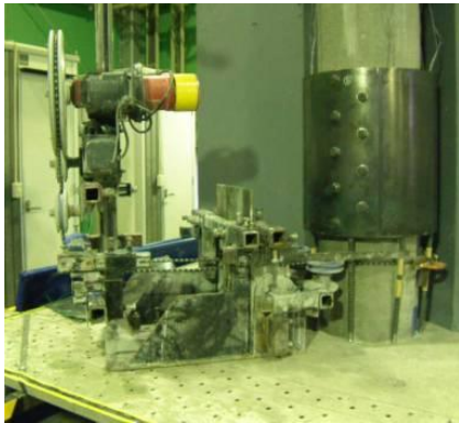
写真-9 PC 鋼材切断状況
