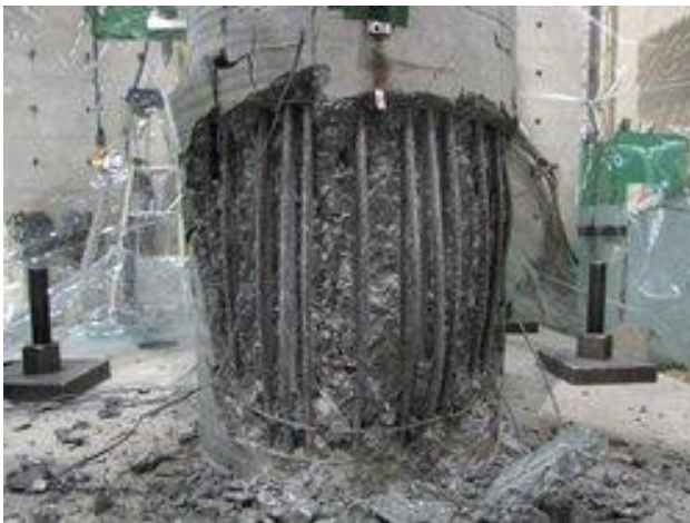
写真-3 基本試験体試験終了時損傷状況
