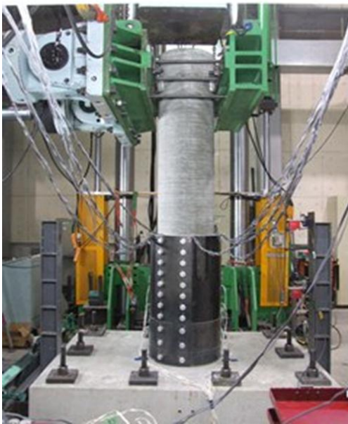
写真-4 補強試験体試験状況
