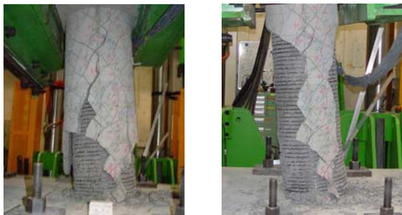
(a) 最大荷重時 ( 6\delta_y : 1/10.3 ) (b) スパイラル帯鉄筋破断直前時 ( 8\delta_y : 1/7.8 )
