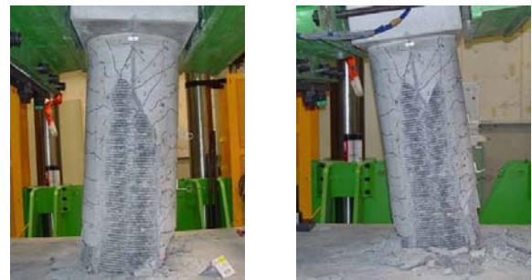
写真-1 曲げ破壊（フーチング）の損傷状況（試験体 A）
