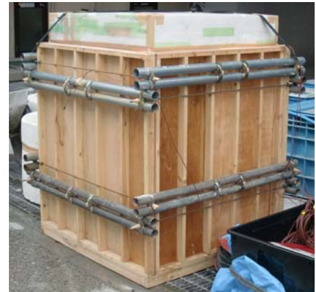
写真- 1 実験で用いた模擬柱部材の例
