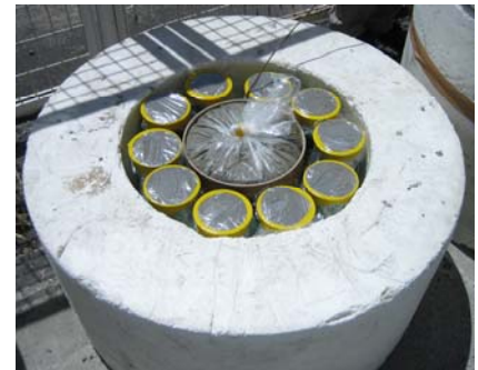
写真- 2 簡易断熱供試体の断熱型枠への設置状況
