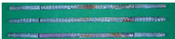
写真-11 M-0.3mmにおける11年暴露試験体内の鉄筋
