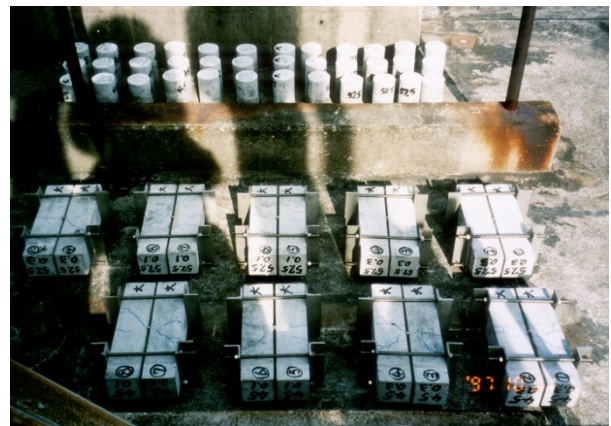
写真-4 供試体の暴露状況
