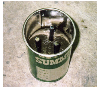
写真-1 暴露供試体Aの概要（円柱供試体）
