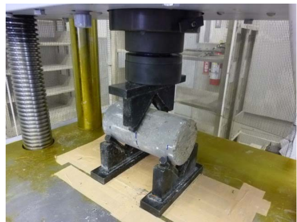
図-2 簡易曲げ強度試験の試験状況
