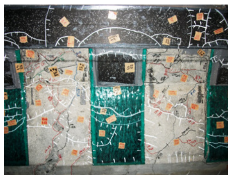
写真-4 ハンチ部の状況 (Case4 供試体 破壊直前)
