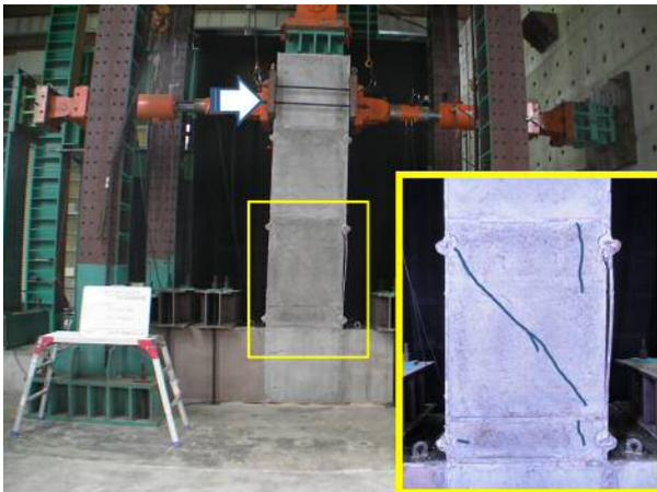
写真-2 ひび割れ状況（負側 3 サイクル目）
