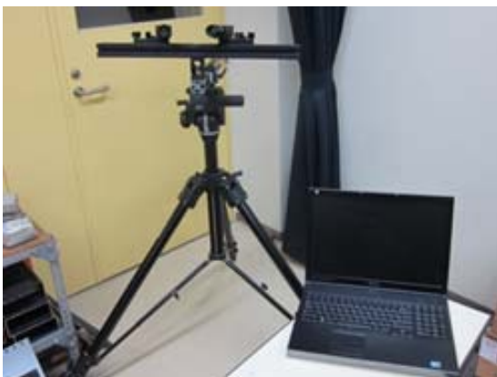
図－2 画像関連法の計測システムと計測結果(最大主ひずみ分布) 1)
