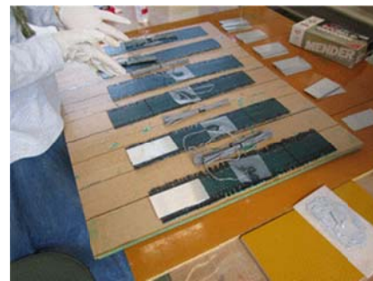
写真一 CFRP 積層板の作製
