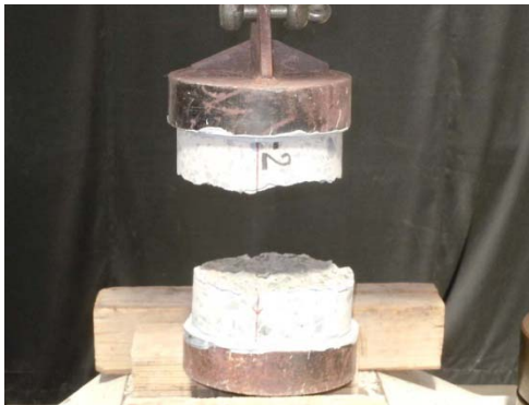
写真-2 直接引張強度試験
