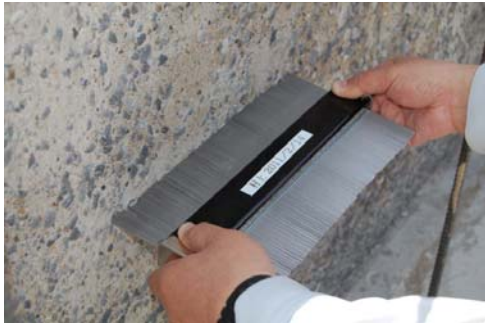
写真-1 打継目の凹凸深さの測定
