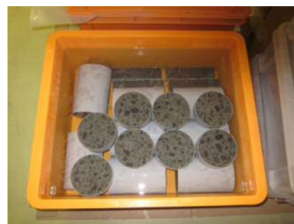
写真-1 供試体の浸せき状況
