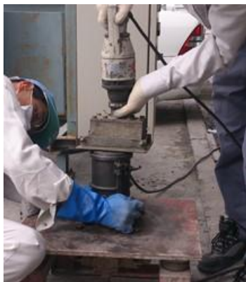
写真-1 振動締固めの様子
