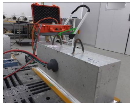
写真-2 表面透気試験状況
