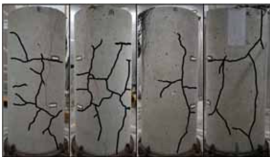
写真 - 2 (a) 円柱表面に入ったASR劣化ひび割れ (ケース の終了時の供試体表面のひび割れ状況)
