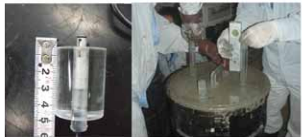
写真 - 1 温湿度ユニットとその設置状況
