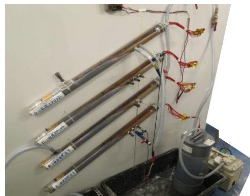
写真-2 \text{LiNO}_2 水溶液注入状況
