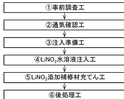
図-1 本補修工法の施工フロー
