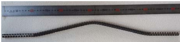
図-5 加力後の試験体（健全鉄筋 32d）
