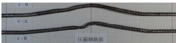
図-1 電食した圧縮鉄筋の座屈の様子 1)
