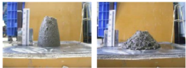
スランブコーン引上げ時 フロー350mm 時 写真-2 崩壊に分類されるコンクリート
