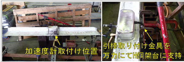
写真-4 振動トンボの加速度計測状況
