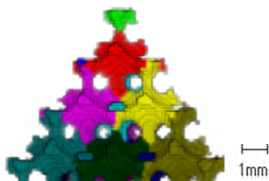
図-4 セラミック球の間隙分離状況
