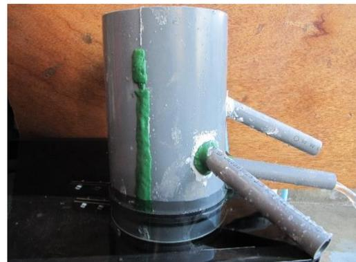
写真-1 透水試験（水位差1cm）の様子
