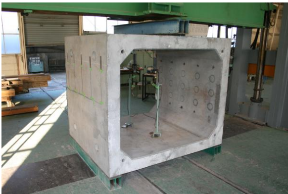
写真-3 外圧試験の状況
