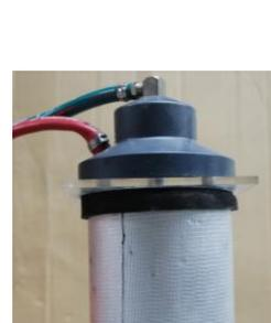
写真-2 トレント透気係数測定時の様子
