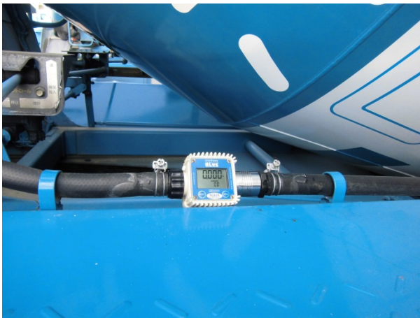
写真-1 流量計の取り付け状況
