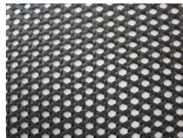
写真-1 CFRP メッシュ筋の形状
