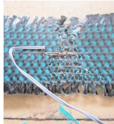
写真-3 CFRP メッシュ筋積層板の破断例
