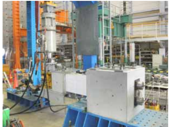
写真 - 1 載荷装置
