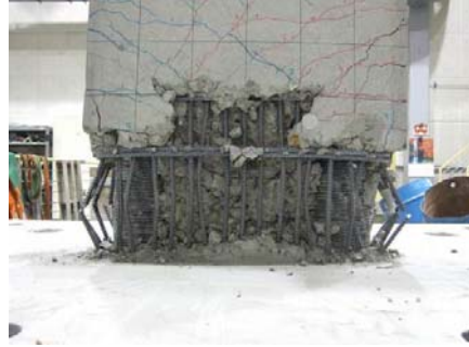
写真-8 No.4 柱基部の損傷状況
