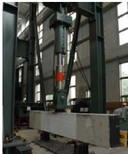
写真-4 載荷装置
