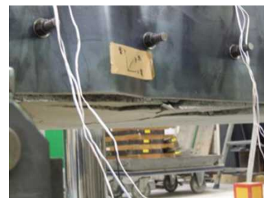
写真－２ 補強鋼板の局部座屈状況 (A-1)
