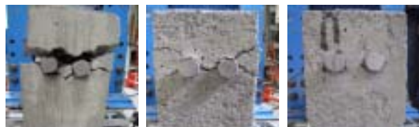
シリーズ1 主筋2本 せん断補強 無 GFRP繊維 無 写真 - 1 最終破壊状況 No.1 シリーズ1 主筋2本 せん断補強 有 GFRP繊維 無 写真 - 2 最終破壊状況 No.6 シリーズ1 主筋2本 せん断補強 有 GFRP繊維 有 写真 - 3 最終破壊状況 No.12
