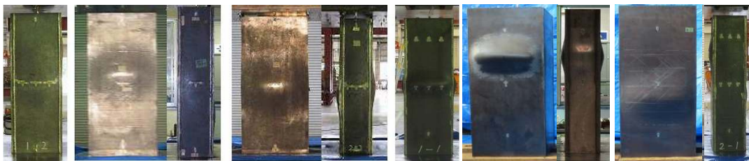
写真-4 CFT 試験体破壊状況
