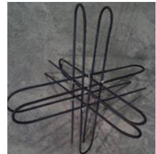
写真-6 内部鉄筋形状
