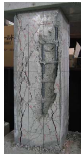
試験体 S2 (2面補強)
