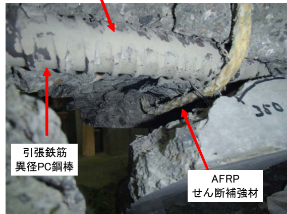
写真-2 AFRP 破断状況(AF1)
