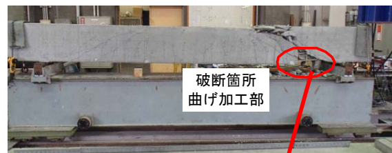
写真-2 AFRP 破断状況(AF1)
