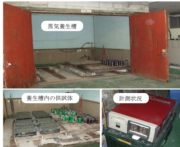
図-5 供試体の蒸気養生
