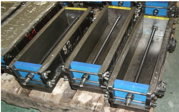
図-3 JIS B 法 拘束膨張試験治具
