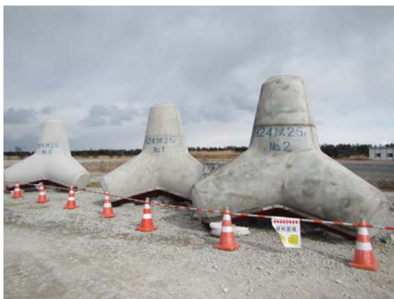
(a) 消波ブロック (プレパックドコンクリート)
