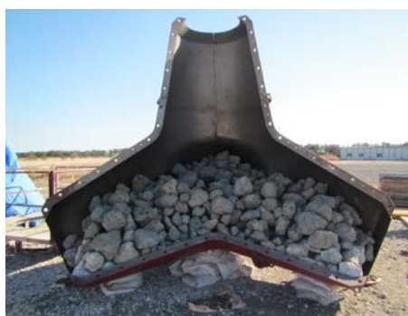
(a) 消波ブロック (プレパックドコンクリート)
