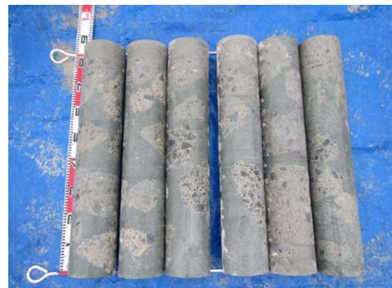
写真-7 試験用ブロックより採取したコア供試体 (プレパックドコンクリート)
