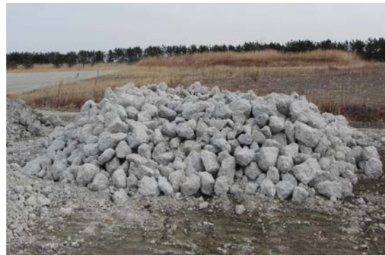
写真-1 震災で発生したコンクリートがら
