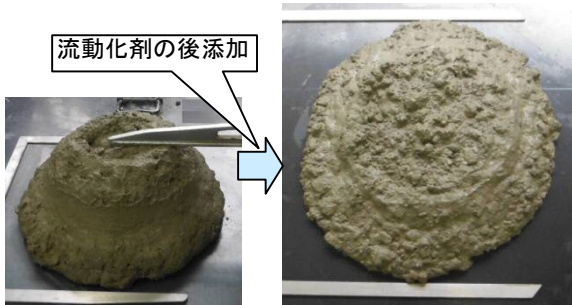
(a)ベースコンクリート (b)中流動コンクリート 写真-2 流動化剤を後添加した中流動コンクリートのフレッシュ性状 (C=360kg/m 3 ,s/a=52%)
