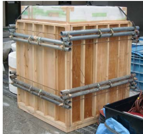
写真-1 実験で用いた柱模擬部材の例
