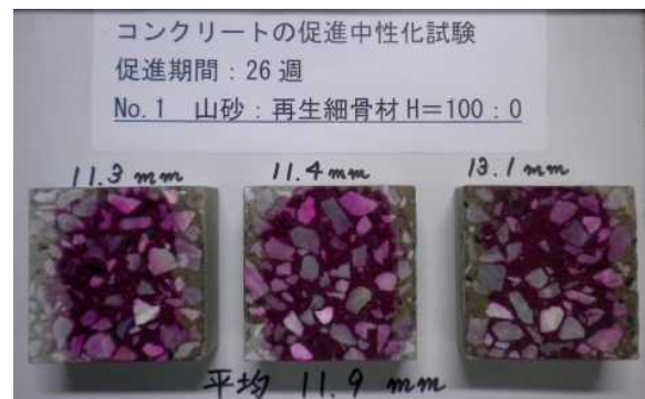
写真-2 中性化深さの状況 (No. 1 26 週)
