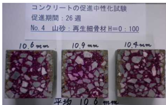
写真-4 中性化深さの状況 (No. 4 26 週)
