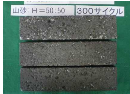
写真-6 凍結融解試験の状況 (No. 2 300 サイクル)
