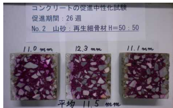
写真-3 中性化深さの状況 (No. 2 26 週)
