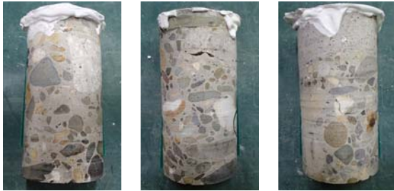
調査箇所 C-1 (23.5N/mm 2 ) 調査箇所 C-2 (27.7N/mm 2 ) 調査箇所 C-3 (25.3N/mm 2 )
