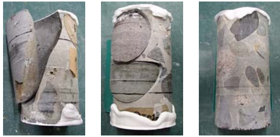
調査箇所 A-1 (15.0N/mm 2 ) 調査箇所 A-2 (13.6N/mm 2 ) 調査箇所 B-1 (20.8N/mm 2 )
