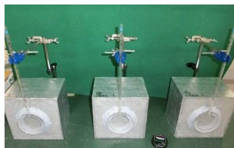
写真-1 表面吸水試験
